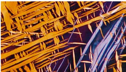
Mechanische Zwillinge in hochreinem Magnesium (99.8% Mg), Essig-Pikrin-Ätzung, polarisiertes Licht (50x)
