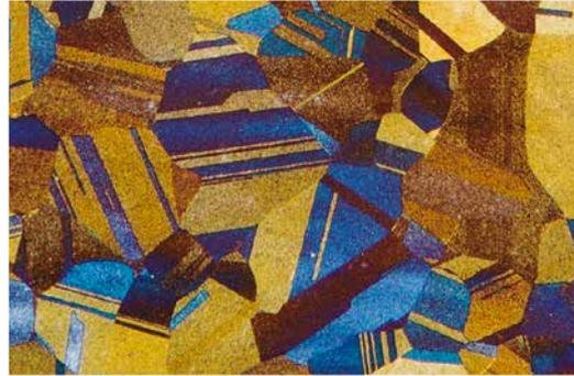
Äquiaxiale Kornstruktur einer Elgiloy-Legierung (Co – 20% Cr – 15% Fe – 15% Ni – 7% Mo – 2% Mn – 0.15% C – 0.05% Be) nach dem Warmwalzen, farbgeätzt nach Beraha, polarisiertes Licht (100x)
