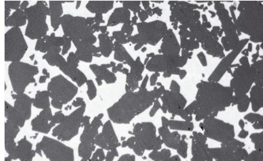
Mikrostruktur einer gepressten Siliziumnitrid-Keramik
