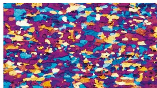
Kornstruktur einer 5754 Aluminiumlegierung durch Anodisierung nach Barker (30 V, 2 min) betrachtet unter polarisiertem Licht (100x)
