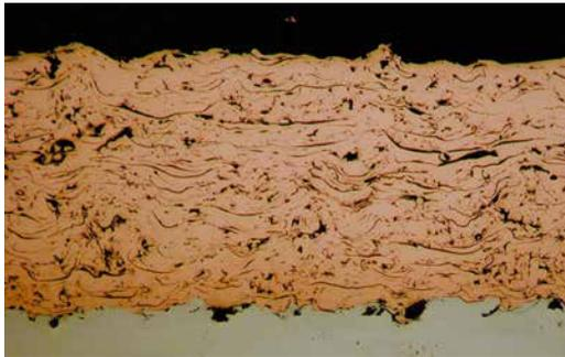
Thermische Spritzschicht, erfasst mit 1200 x 1600 Pixeln
