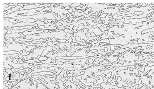
Elektrolytisch geätzte Mikrostruktur in Duplexstahl mit (c) wässriger 60% HNO<sub>3</sub> (1 V, 20 s), (d) wässriger 10% Oxalsäure (6 V, 75 s), (e) wässriger 10% CrO<sub>3</sub> (6 V, 30 s) und (f) mit wässriger 2% H<sub>2</sub>SO<sub>4</sub> (5 V, 30 s) (200x)
