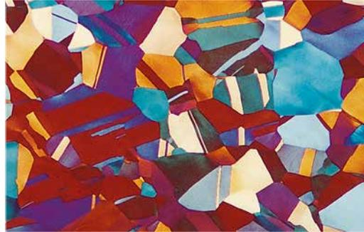
Alphaphase mit Rekristallisationszwillingen in einer kaltverformten und geglühten Arsen-Bronze-Legierung
