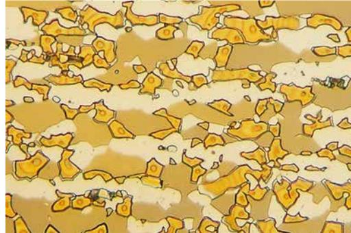
Mikrostruktur einer austenitisch-ferritischen Duplexprobe (Ferrit braun, Austenit weiss). Die Probe wurde bei 816 °C 48 h gehalten, um die Sigma-Phase zu formen (orange Partikel). Elektrolytisch geätzt in 20%-iger wässriger NaOH-Lösung (Natriumhydroxid) bei 3 V, 9 s (500x)
