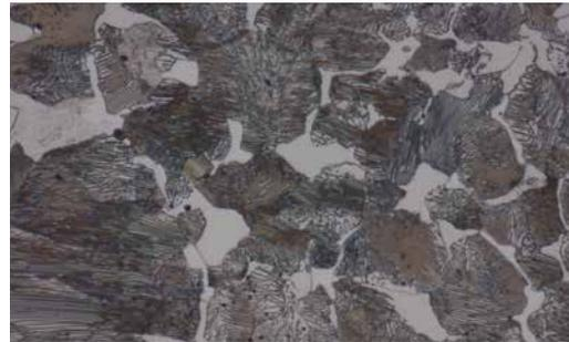
Normalisierter C-Stahl mit Ferrit und Perlit (lamellarer Zementit). Geätzt mit 3% Nital (200x).
