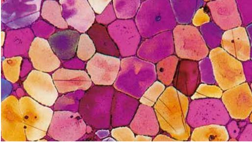
Gussstruktur einer Magnesium-Legierung mit 2.5% Seltene Erden, 2.11% Zn und 0.64% Zr, zeigt einen Film auf den Korngrenzen der Erdmetalle und Ausscheidungen in den Körnern (Kornfarbe variiert durch Kornausrichtung). Vereinzelt mechanische Zwillinge in den Körnern, Essig-Pikrin-Ätzung, polarisiertes Licht (100x)
