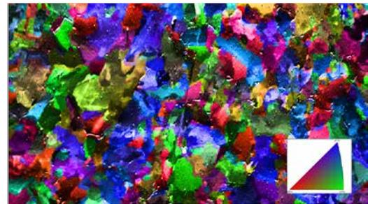
Vibrationspolierter ferritischer Stahl, REM-Aufnahme mit dem Overlay der Orientierungskarte für  $\alpha$ -Eisen.
