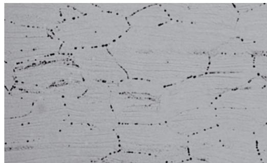
Korngrenzausscheidung in einer kaltgewalzten Nb - 28 % Ta - 10.5 % W - 0.9 % Zr Legierung im Längsschliff 500 x, Ätzung: Milchsäure, Salpetersäure und Flußsäure im Verhältnis von 30:10:5.
