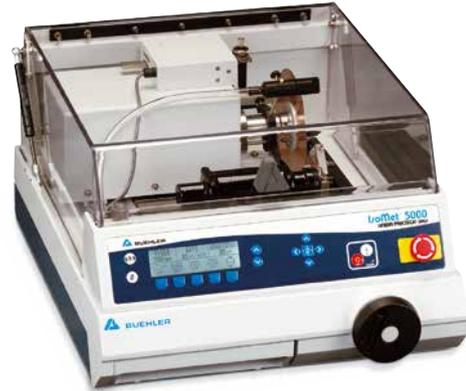
IsoMet Präzisionstrennmaschine mit Fahrschnitt
