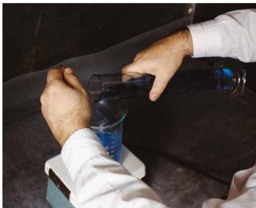
Beim Mischen von Lösungen immer einen Magnetrührer verwenden und Lösung langsam hinzufügen. Wenn es sich um gefährlichere Lösungen als diese hier handelt, sollte unbedingt die persönliche Schutzausrüstung (PSA) getragen werden
