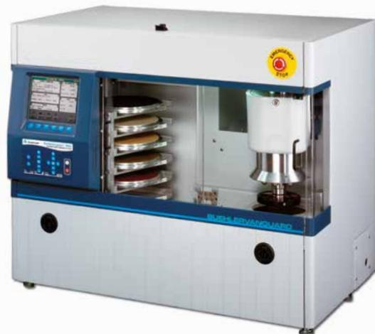
BuehlerVanguard 2000 vollautomatisches Präparationssystem
