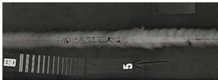
» Hegesztési varrat képe: képmínőség CR-vizsgálattal
